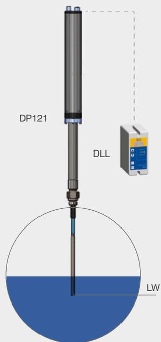
**Livellostato conduttivo basso livello (LW Limiting) Serie DP121+DLL**
