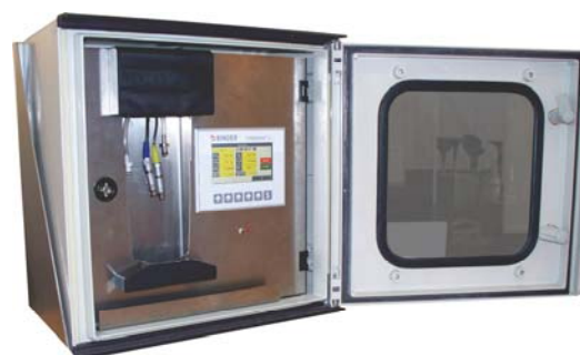
COMBIMASS® GA-s, con analizzatore rimosso per misura a distanza.
